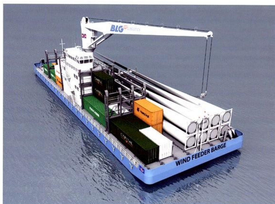
Wind Feeder Barge für den Transport und selbstständigen Umschlag von Offshore-Windenergie-Komponenten
